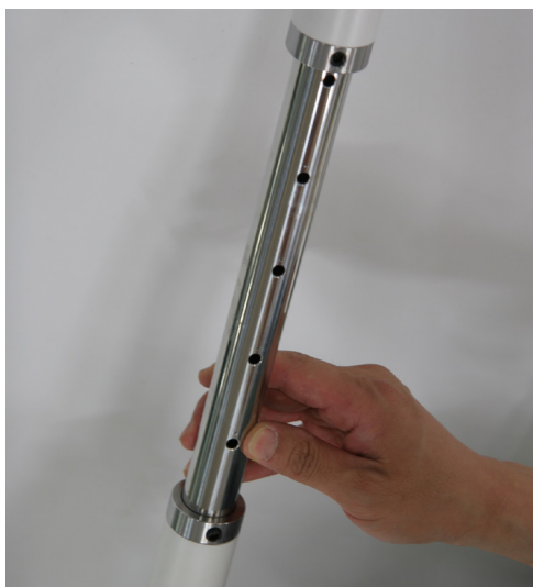
[그림 19] 높이조절형 뒷다리부, 높이조절부, 아랫다리부 CNC모듈
